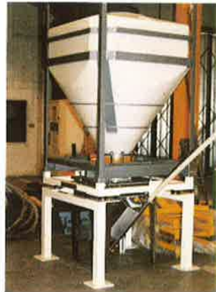
(T7 型) マルチ式ディスチャージャ 金属製・プラスチック製の容器 からの原料排出用ディスチャー ジャ
