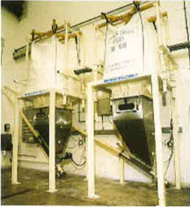
(T2 型) 容積式ディスチャージャ 標準型で各種輸送機に接続可能
