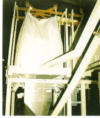
(T3 型) 重量式ディスチャージャ ロードセルを用いて原料の量を計り、 ロス・インウェート（減量制御）式で 原料を制御排出します
