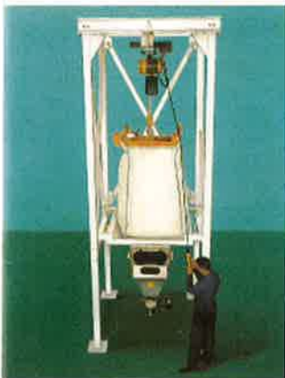
(T6 型) ホイスト付ディスチャージャ フォークリフトが使用不可能な場合 にホイスト一体型ディスチャージャ
