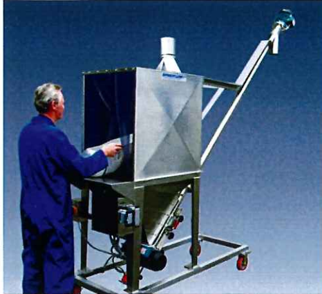
可動式のフレキシブルコンベヤです。 紙袋の原料を充填し、次工程へ搬送
