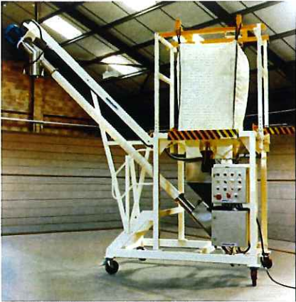
可動式のフレキシブルコンベヤです。 フレコンから原料を次工程へ充填
