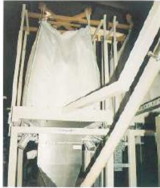
(T3型) 重量式ディスチャージャ ロードセルを用いて原料重量を計り ロスインウェイト（減量制御）式で 原料を制御排出します
