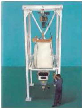
(T6型) ホイスト付ディスチャージャ フォークリフトが使用不可能な場合 にホイスター体型ディスチャージャ でバッグセットを容易に実現
