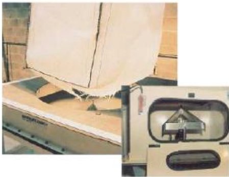
(T4型) ワンウェイバッグ用ディスチャージャ 固定ナイフ式・空圧作動ナイフ式の2種が あり、バッグ底面を破り発塵無く排出可能
