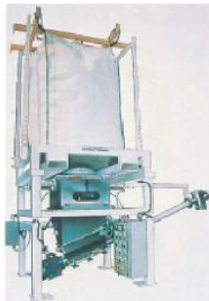
(T5型) 低スペース用ディスチャージャ 上部フレームが分解可構造で床に置かれた 上部フレームをフォークリフトで持ち上げ てセットします。そのベースにフォーク チャンネルが装備されております
