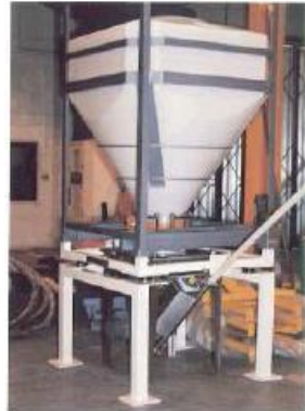
(T7型) マルチディスチャージャ 金属製・プラスチック製の容器 からの原料排出用ディスチャー ジャ
